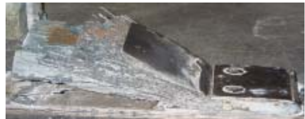
図 3 裏込めが固化したワイヤーブラシ
