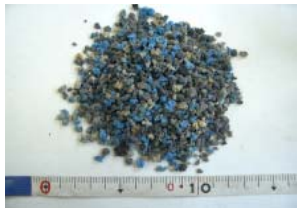
写真-3 塩ビ樹脂廃材のスポンジ状ペレット
