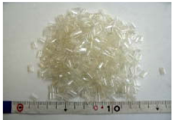
写真-2 ペットボトルのストロー状ペレット
