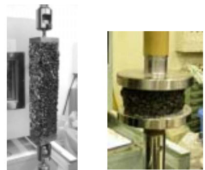
(左)直接引張試験 (右)圧縮試験
