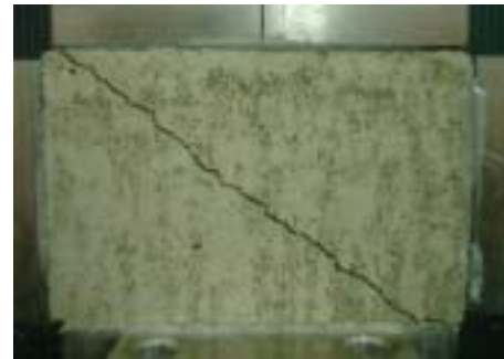
Fig7 供試体破壊状況
