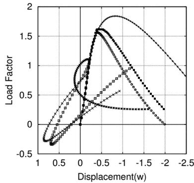
図-8 弧長一定による分岐経路
