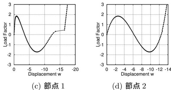
図-7 制御変数が節点2の鉛直変位
