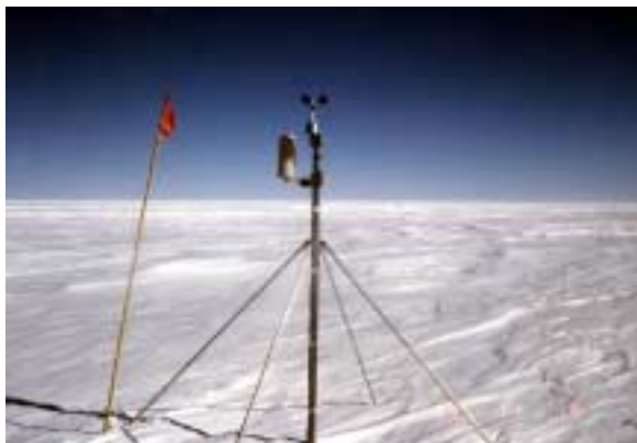
図 - 6 南極みずほ基地の自動気象観測装置
