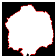
図-4.8 モノクロCCDカメラでの降雪時におけるハロゲンランプの輪郭抽出結果
