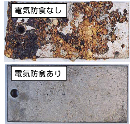
図 4 電気防食試験における外観写真（平板 B 片、150×70×9 mm）
