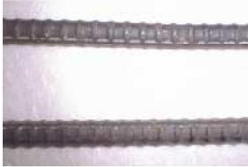
図-8 腐食状況 (W/C30%, ひび割れ幅 0.223mm)
