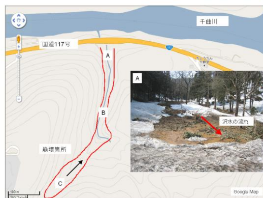
図 4.3.3_4 セヶ巻の崩壊箇所
