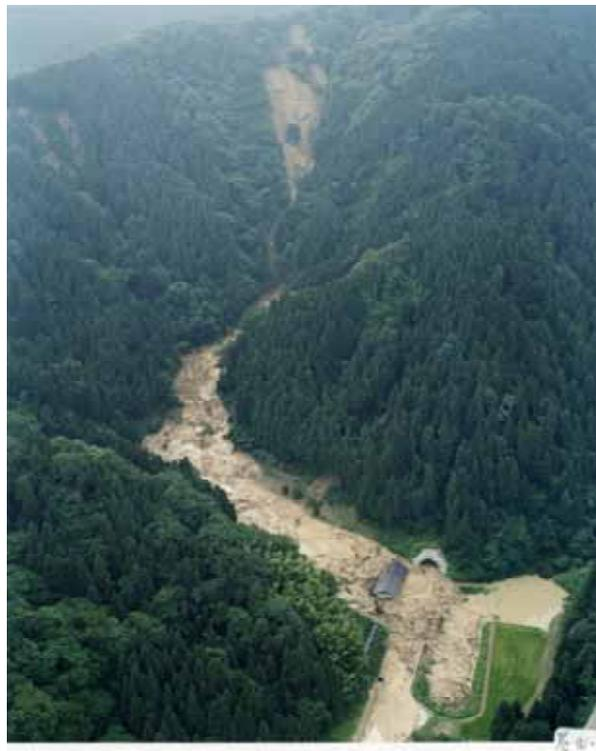
図 6-28 三島町中永トンネルの坑口土石流被害（新潟県提供）
