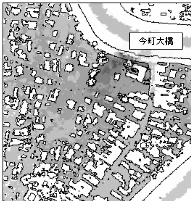
図 4-4 計算による最大水位分布 (m) (左: 破堤流量 99\text{m}^3/\text{s} 、右: 破堤流量 495\text{m}^3/\text{s} ) 図のサイズ 縦:451m、横:351m
