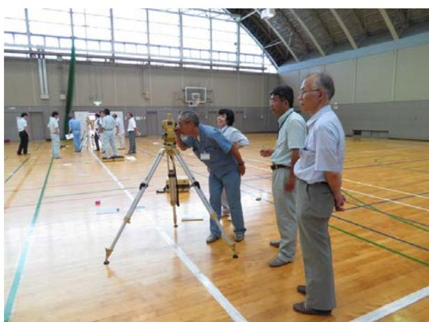
図2 トータルステーションを用いた測量
