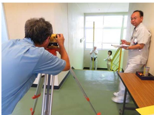
図3 オートレベルを用いた水準測量
